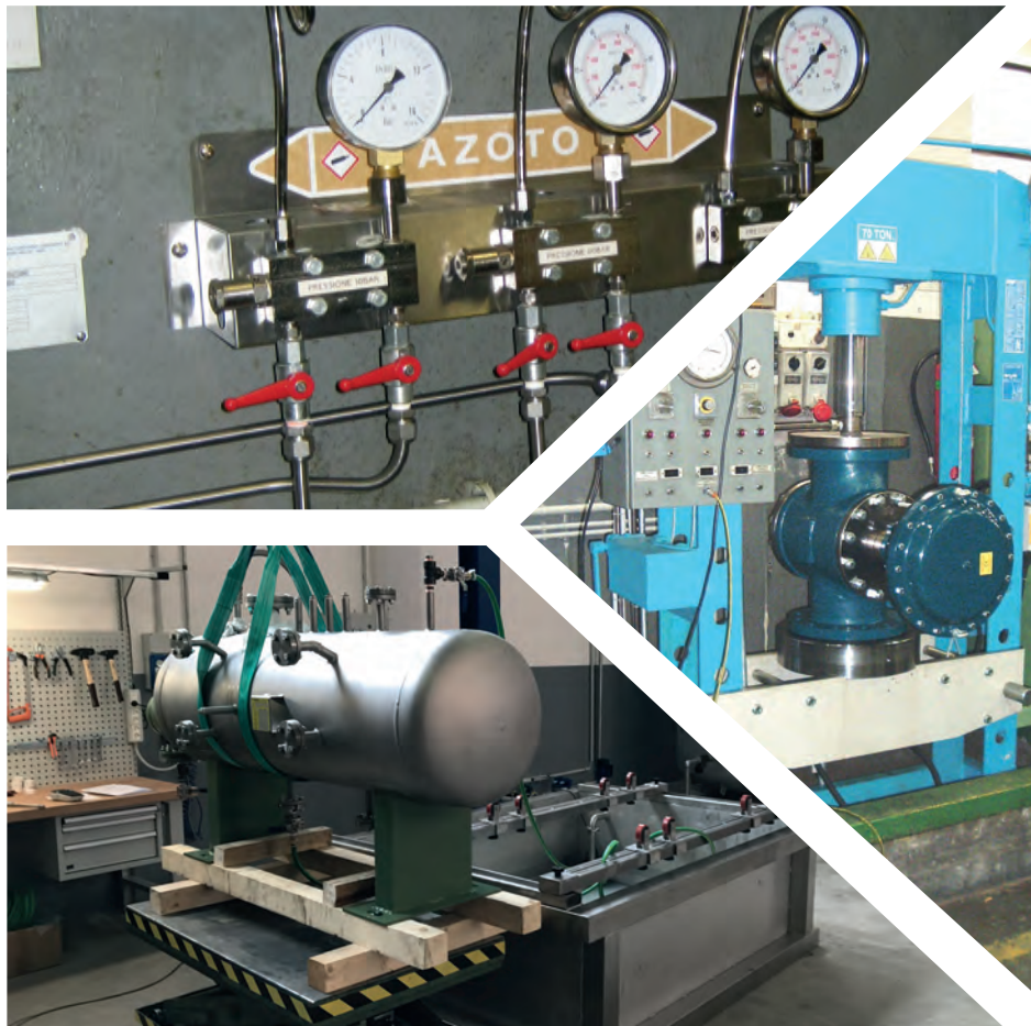
TEST IN ACCORDO ALLE NORME EN - API CON ACQUA E AZOTO FINO A 250 BARG
